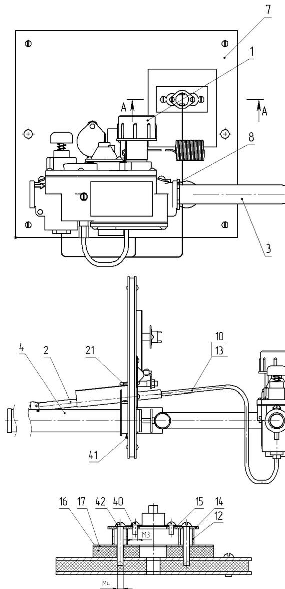
1-блок управления; 2-блок запальника; 3-коллектор; 4-труба горелочная; 7-панель; 8-гайка; 10-трубка запальника; 12-втулка; 13-прокладка;14-панель; 15-шайба; 16-теплоизоляция; 17-пластина; 21-термопара; 40-винт М3; 41-винт М4х8; 42-винт М4х22
